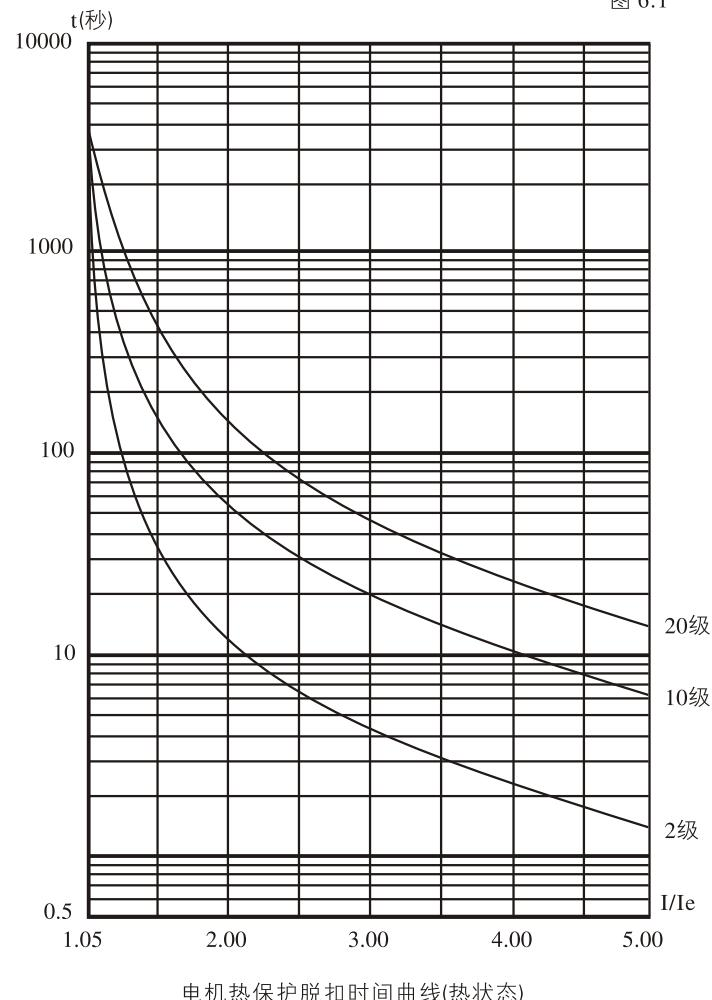
电机热保护脱扣时间曲线(热状态)
